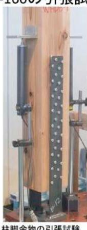
柱脚金物の引張試験
